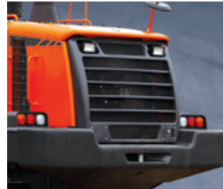
Rejilla del radiador (de acero)
