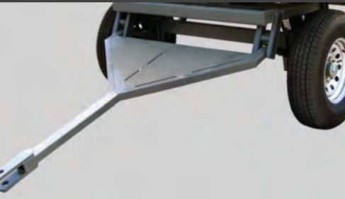
Eje de alto despeje, lanza reforzada y quinta rueda que abarca todo el ancho del chasis para una mayor estabilidad durante la carga y el transporte.
