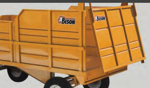
Piso de lámina y redilas desmontables atornillables a la plataforma.
