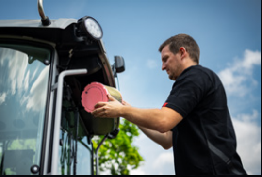
Acceso fácil al filtro de aire de la cabina a efectos de limpieza.
